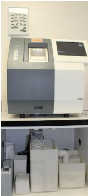
Moderne Einschleifmaschinen mit Schleifwasserrückgewinnung helfen, auch im Werkstattbereich die Ressourcen-Nutzung zu reduzieren.
